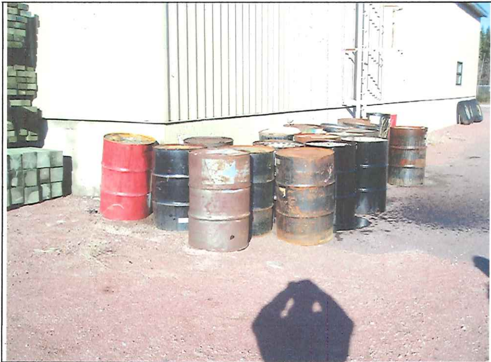
Photo numéro: 4 Date : 26 octobre 2007 Barils d'huiles usées majoritairement pleins entreposés à ciel ouvert à l'extérieur. Un des barils a débordé sur le sol lors d'un remplissage.
