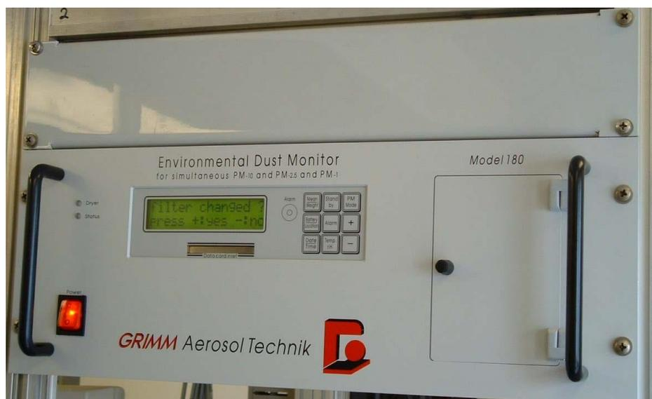
Figure 2: Analyseur de particules en continu GRIMM modèle 180.
