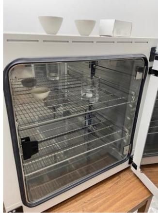
**Figure 11 :** Évaporation du peroxyde d'hydrogène à l'étuve (60 °C)
