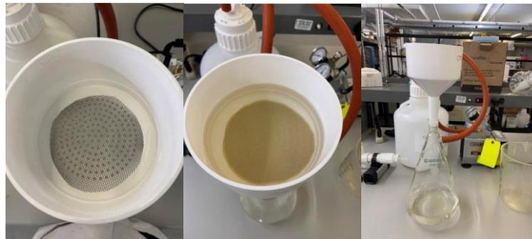
**Figure 9 :** Équipement nécessaire au montage 3 (membrane de verre avec 1.6  $\mu\text{m}$  de porosité)
