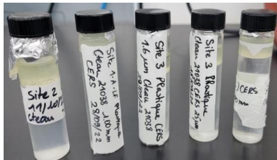
**Figure 13 :** Conservation de la phase huileuse dans les fioles de verre de 25 ml jusqu'à l'étape de coloration
