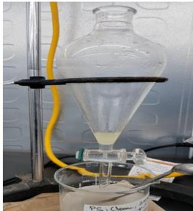
**Figure 12 :** Séparation de la phase Eau-Huile à l'aide d'une ampoule à décanter
