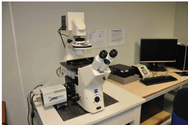
***Figure 16** : Microscopie à fluorescence de type Zeiss Axiovert 200*
