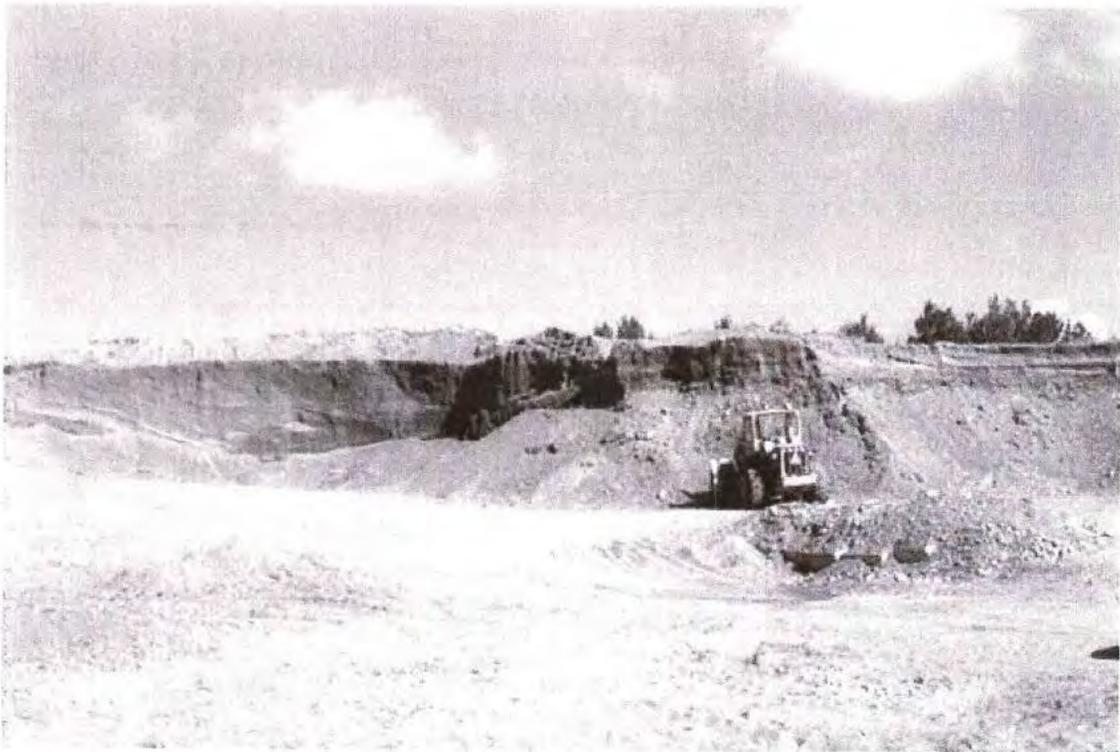
Photo 4: Coupe de 4 à 5 m de hauteur, dans un dépôt fluvioglaciaire, composée surtout de sable stratifié et d'un peu de gravier. Le roc affleure au plancher de l'exploitation (banc 1, gisement 15).
