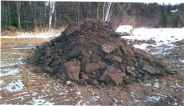
3. Un tas, d'environ 14 mètres cubes, constitué de morceaux d'asphalte non conditionnés dont certains ont plus de 30 cm.
