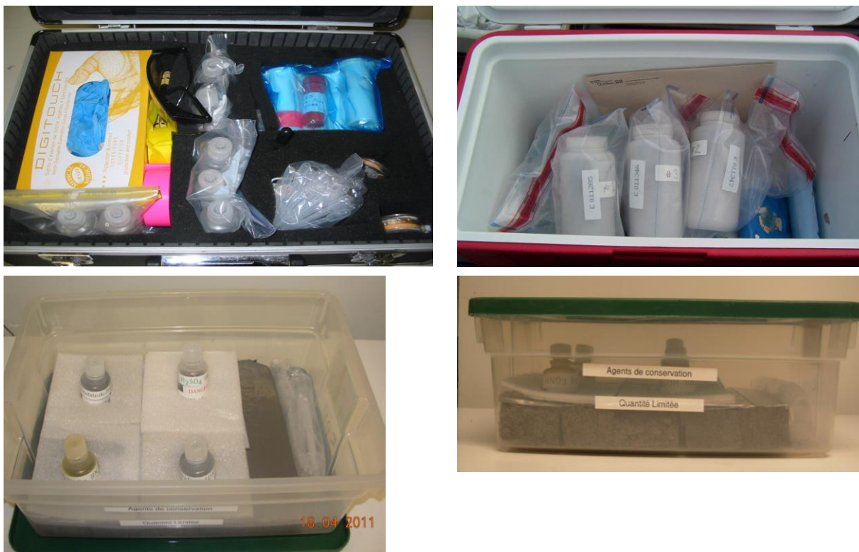
Figure 12 : Exemples de contenants permettant de transporter les agents de conservation et les solvants de décontamination conformément aux dispositions du RTMD
