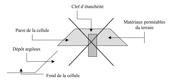
Dans cet article, le premier alinéa du second paragraphe précise qu'une membrane synthétique d'étanchéité doit être **installée sur** la couche de dépôt meuble (niveau composite). La seule exception à cette exigence sera la mise en place d'un géotextile entre la membrane et le dépôt argileux. Cette exception sera permise seulement dans le cas où le fond de la cellule se situerait sous le niveau des eaux souterraines et devra être soumise au Service des lieux contaminés (SLC) pour expertise.
