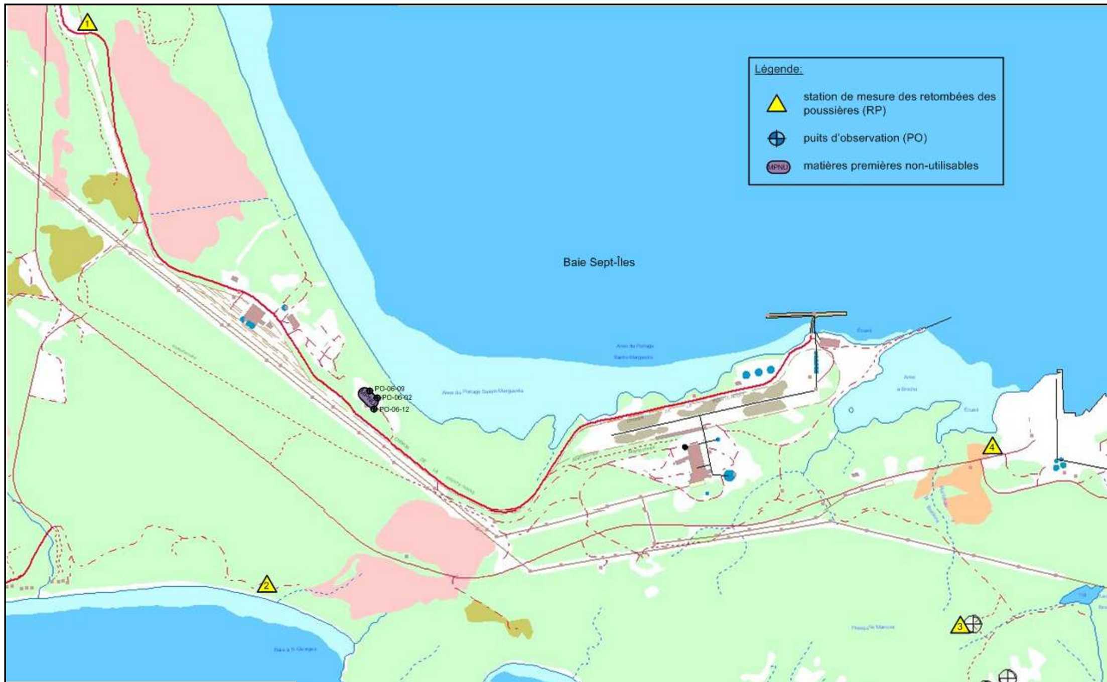
ANNEXE 2-D.1 - Localisation des stations de mesure de retombées des poussières et des puits d'observation Mines Wabush
