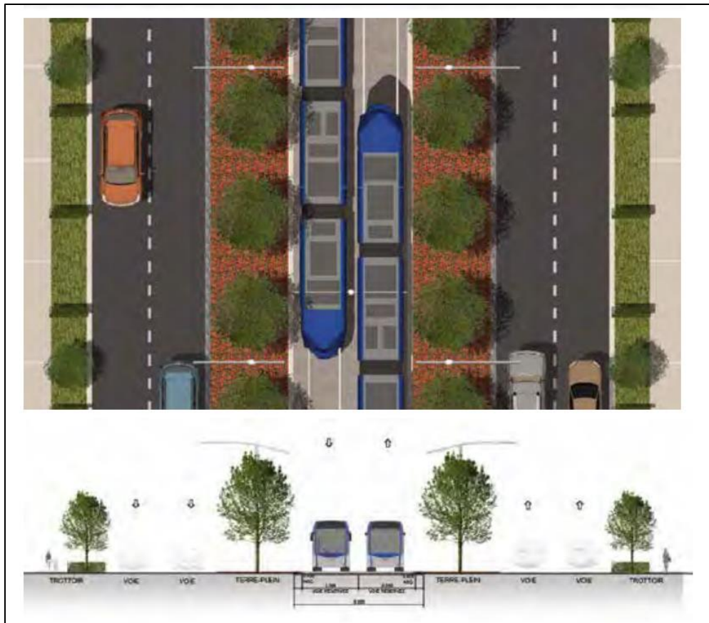
Figure 7.2 Scénario d'insertion selon les contraintes du milieu – Milieu non restreint : emprise de 30 m.
