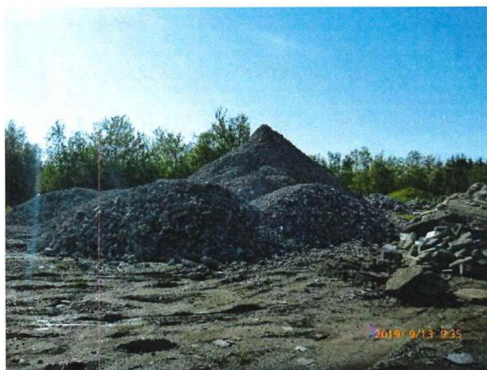
P1040791.JPG Photo 4. Amas de béton concassé (< 30 cm 3 )
