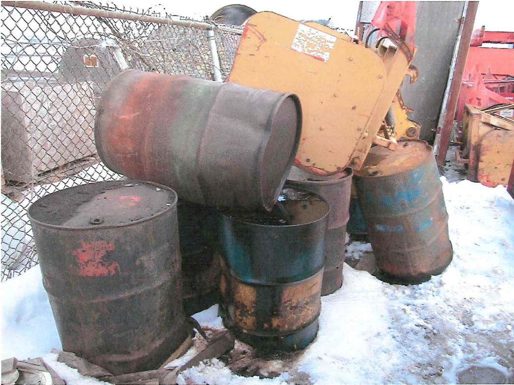
Photo 1: Une dizaine de barils en équilibre parfois précaire, utilisée comme support de pelle. Certains semblent vides et d'autres sont pleins. Une huile noire est visible sur le couvercle de certains contenants et sur le sol.
