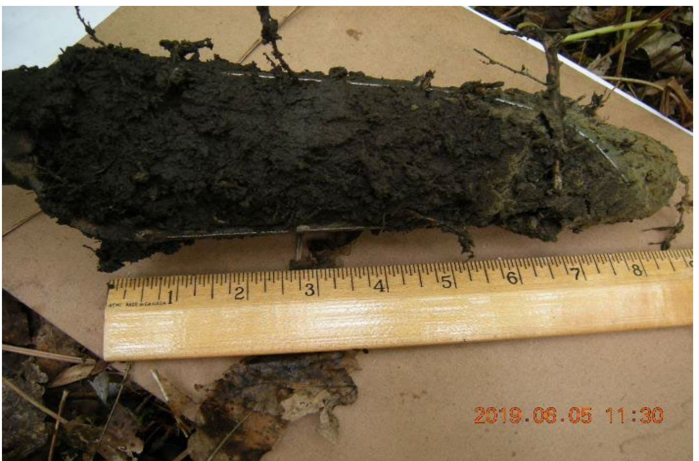
Photo 3 : Station 1. Point GPS 016. Morphologie du sol. Les seize premiers centimètres sont essentiellement de la matière organique suivi ensuite de matériaux sablonneux. Davies, A-M. 2019
