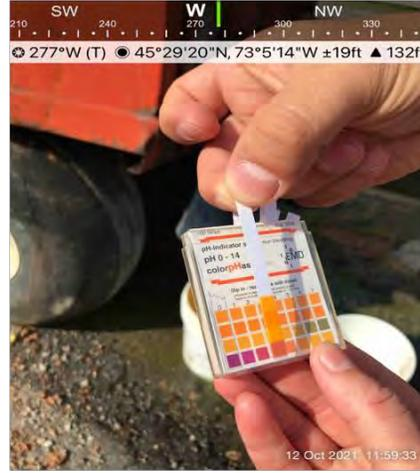
Photo 20211012\_155933247\_iOS.jpg: Le rejet liquide issu du conteneur de pulpe de pommes a un pH de 3 lorsque mesuré avec nos bandelettes
