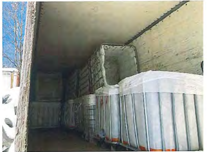
IMG_0010.JPG Totes de récupération d'aluminium entreposées dans une remorque. Les totes strappées sont celles prêtes à être évacuées.
