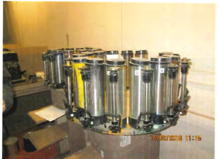
Photo 2 : IMG_2342.JPG Ligne de coloration des peintures
