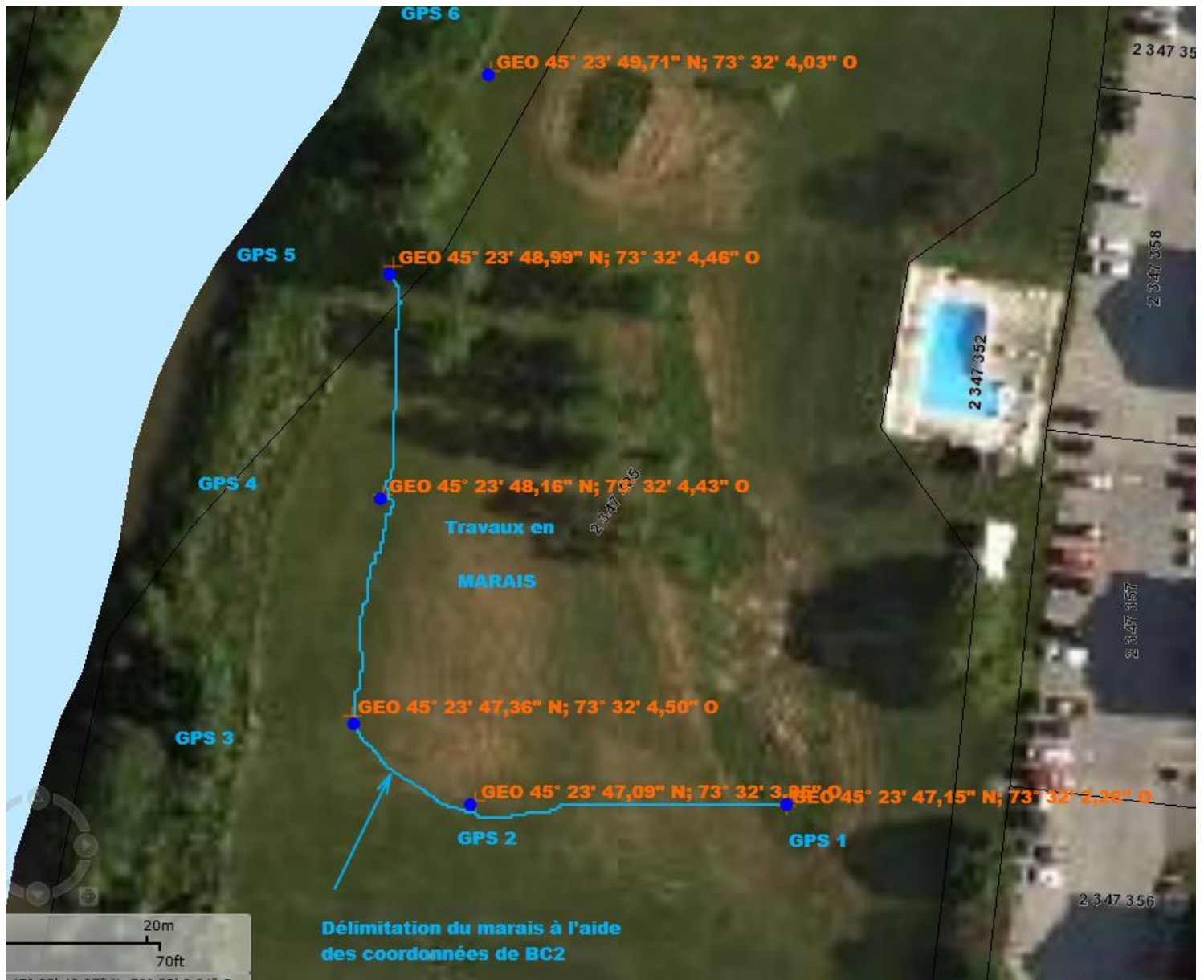
Orthophoto de l'atlas du MELCC : points GPS pris lors de l'inspection; délimitation du marais sur le terrain.
