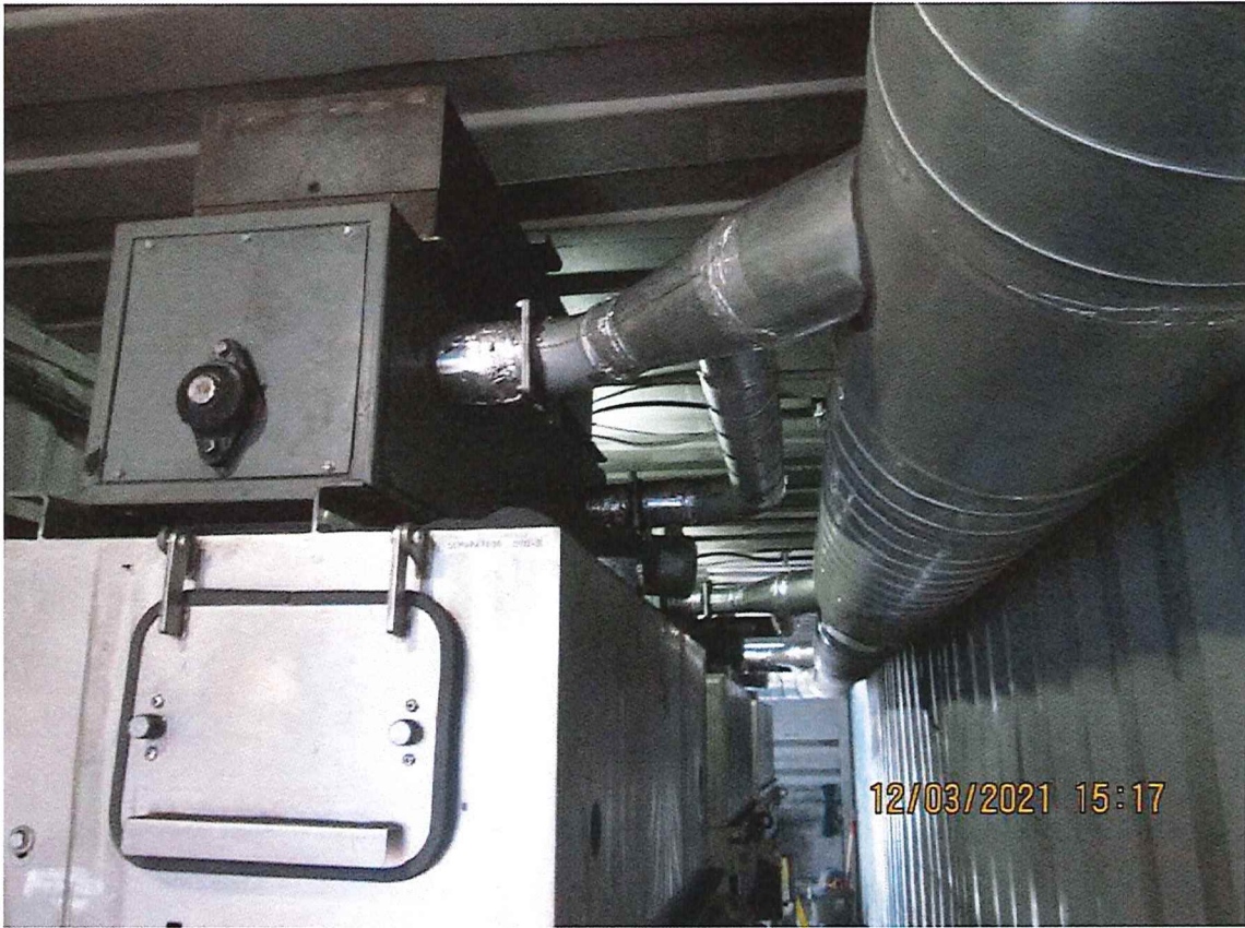
Photo 9: conteneur comprenant les séparateurs magnétiques (#4 sur photo 6)
