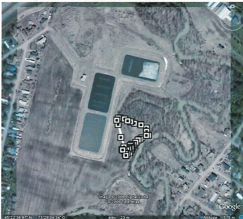
Tracé enregistré par le GPS 1 : Limites de la superficie des travaux, de déblaiement et de remblai, effectués en zone inondable, en rive et en littoral de la rivière Saint-Jacques.
