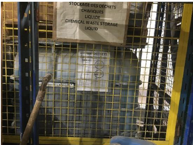
IMG_2073.jpg Photo 31 : Électrolyte de Nickel (tote 1) entreposé sans bassin de rétention et sur plus d'un (1) an.
