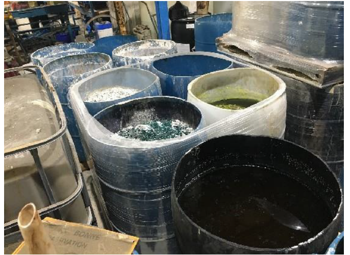
IMG_2057.jpg Photo 26 : Barils pleins de boues sèches prêts à être disposés et entreposés sans étiquettes indiquant non et date. Baril noir avec MDR liquide et pas de muret pour faire bassin de rétention en cas de déversement.
