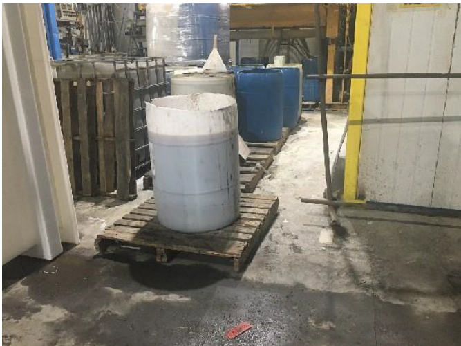
IMG_2067.jpg Photo 27 : Baril en remplissage par un employé qui faisait du lavage de tote de MDR dans la zone d'entreposage des MDR sans bassin de rétention - Déversement sur le plancher.
