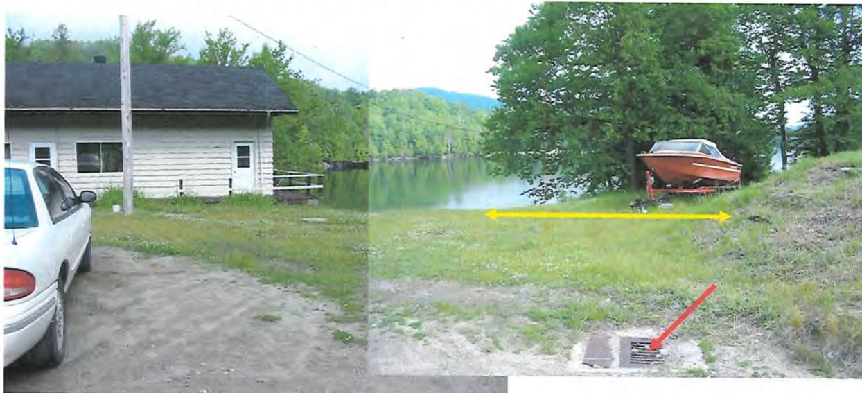
**Photo no. 2 :** Flèche rouge : un puisard recueille les eaux de surface de l'aire de stationnement. Flèche jaune; Localisation approximative de l'élément épurateur. Le lac Laurel se trouve en arrière-plan. Pas de résurgence constatée.
