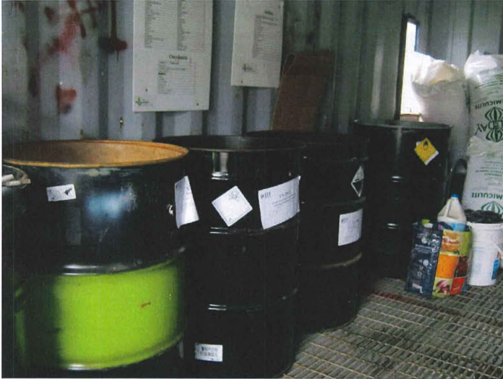
Photo 10. Entreposage de matières dangereuses résiduelles à l'intérieur d'un conteneur.
