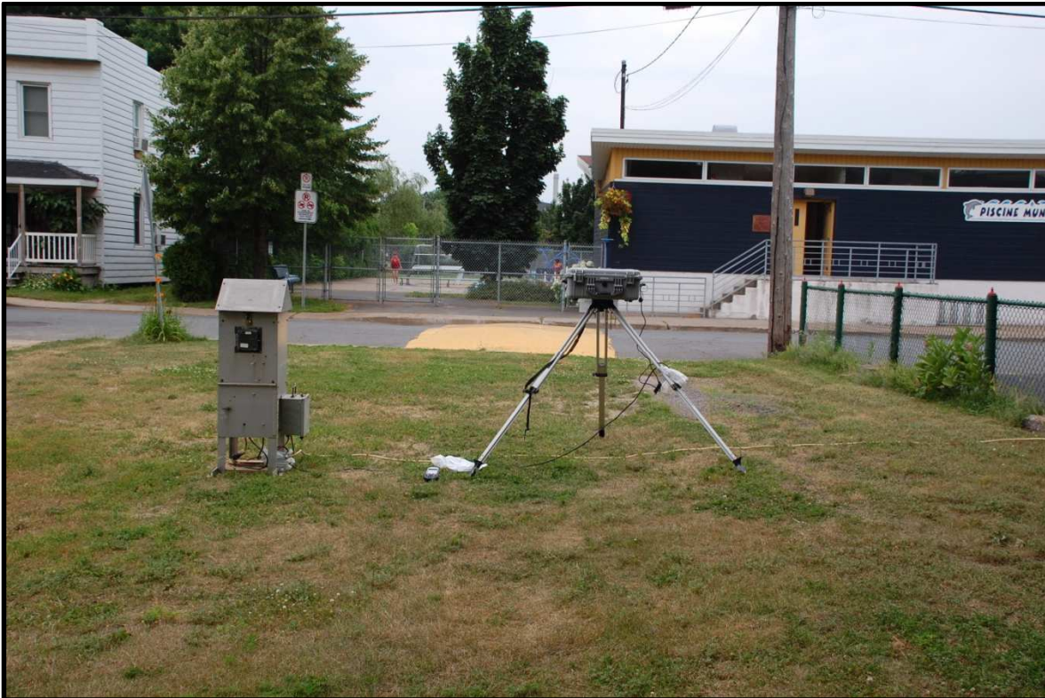
Photographie 4 : terrain vague à côté du 122 rue St-Joseph, Hi-Vol et DustTrak (T3).
