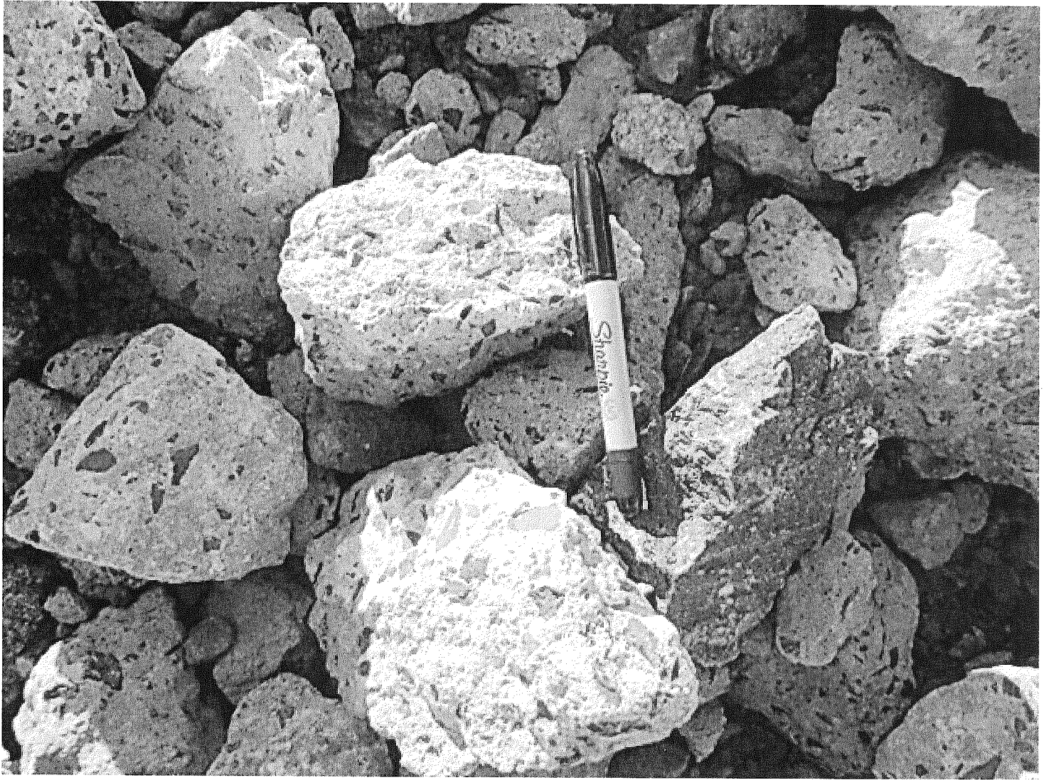
Photo 015.jpg Taille des agrégats issus du concassage des résidus de béton (15 cm)
