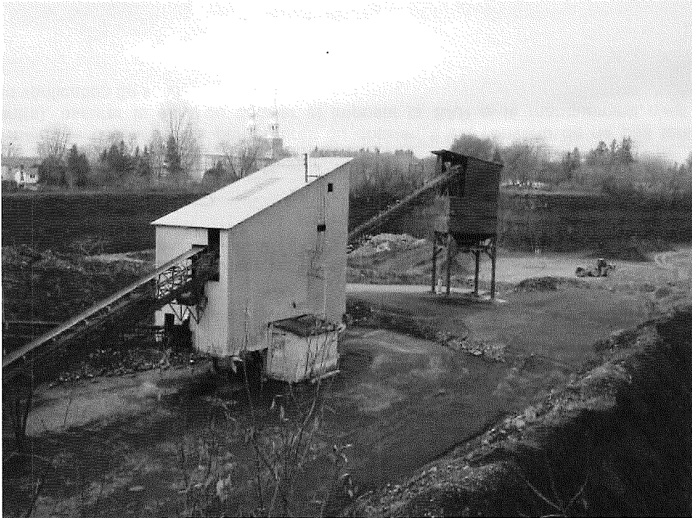
Image 2. Concasseur secondaire (plus en fonction).
