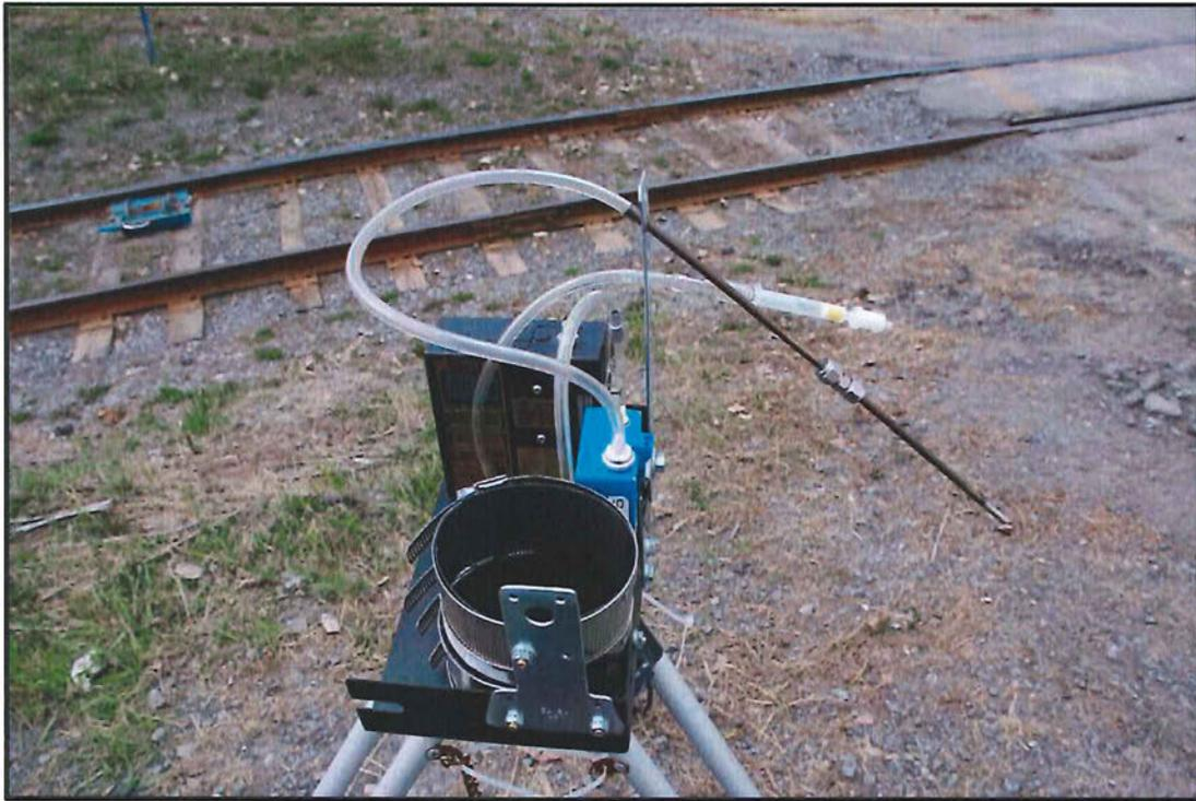
Photographie 11 : Montage utilisé pour le prélèvement des tubes TENAX et LpDNPH.
