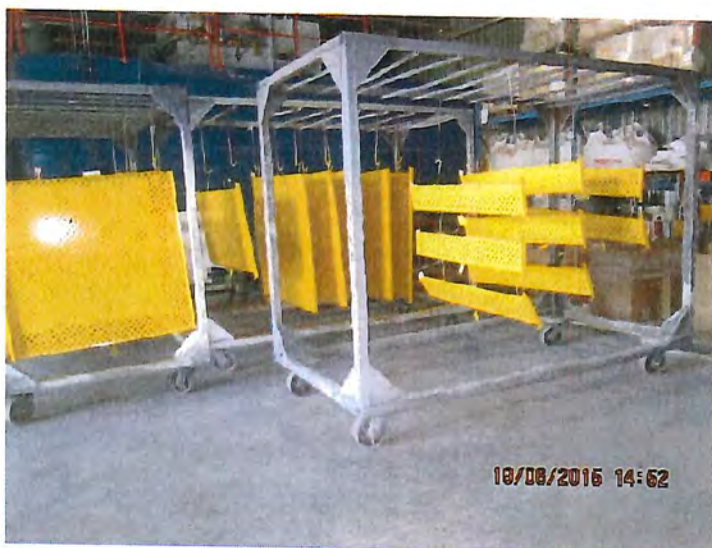
Photo 5 : IMG_0603.jpg : pièces métalliques finies peinturées.
