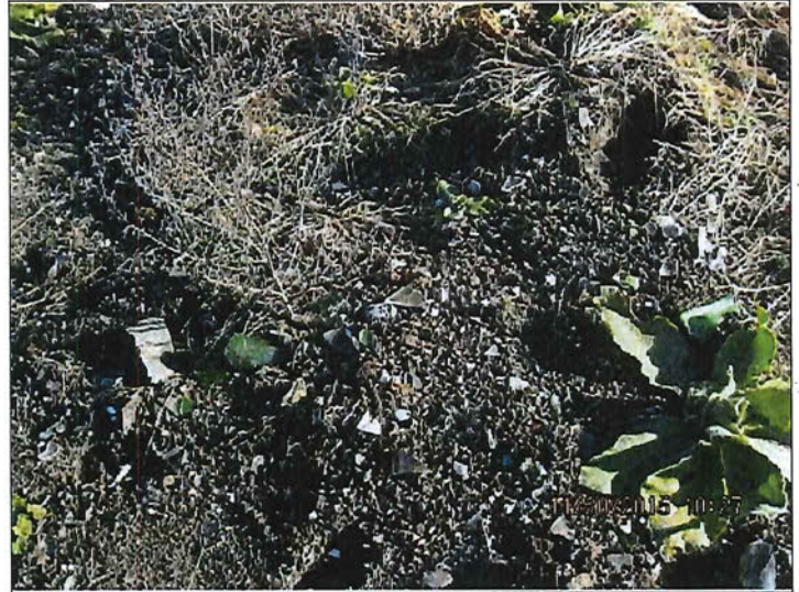
IMG_3517.JPG photo 16 : Morceaux de verres brisés à l'intérieur du matériel de remblai.
