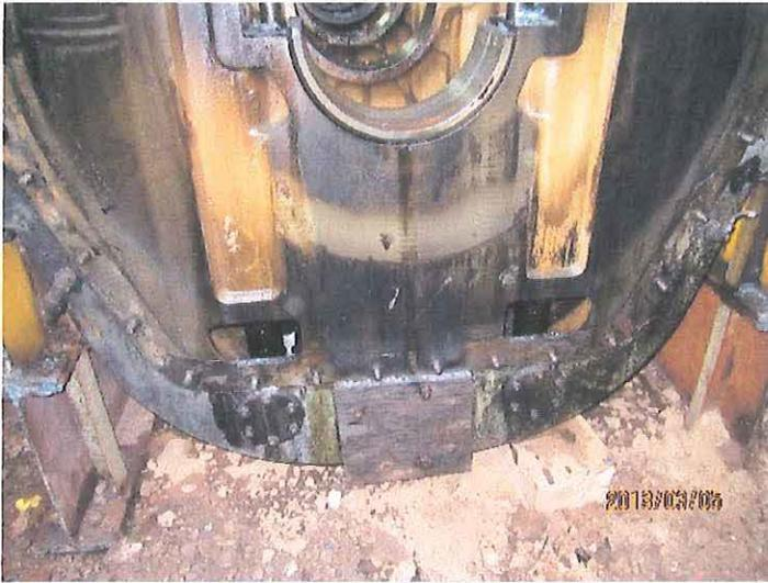
Photo7. Traces d'huiles sur la structure d'un autre ancien moteur.
