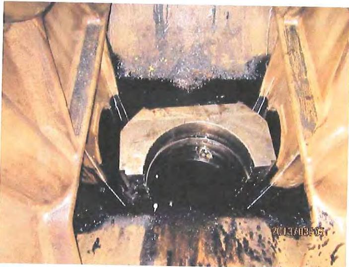
Photo3. Intérieur de la structure à la base du moteur, présence d'huile.
