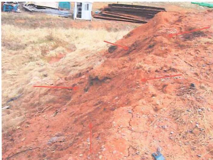
Photo 6. Sol souillé sur la pente. Odeur d'hydrocarbures.
