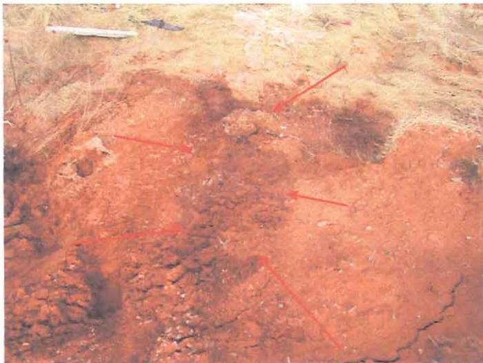
Photo 7. Sol souillé, odeurs d'hydrocarbures(pente).
