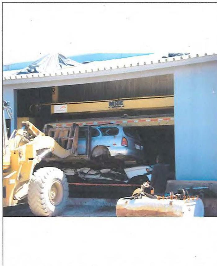
Photo 14. Pressage en bloc de deux VHU dans la presse.
