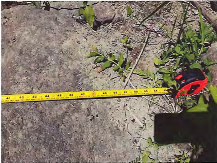
Photo 11. Mesure de la distance entre la LHE et les derniers sédiments de sable et gravier observés (Orientation : Ouest)
